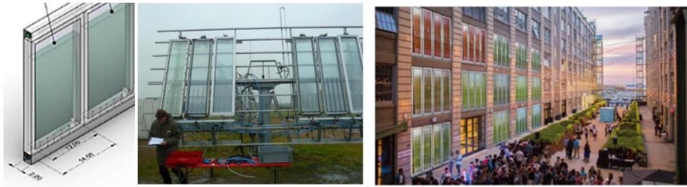
Gambar 8. Desain prototipe pelat bioreaktor mikroalga untuk diaplikasikan pada bagian fasad bangunan Sumber : Thermal and Energy Performance of Algae Bioreactive Façades, Journal of Building Engineering
