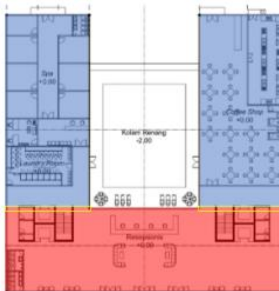
Gambar 18. Dilatasi Bangunan Hotel (Sumber: Penulis, 2023)
