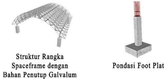
Gambar 8. Struktur pondasi setempat dan bentang lebar
