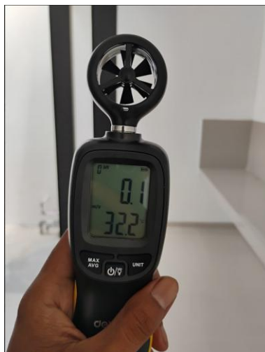
Gambar 3 Digital Anemometer untuk mengukur kecepatan udara Sumber: Dokumentasi penulis 2025
