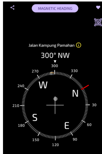
Gambar 4 Digital Compass untuk melihat orientasi bangunan Sumber: Dokumentasi penulis 2025
