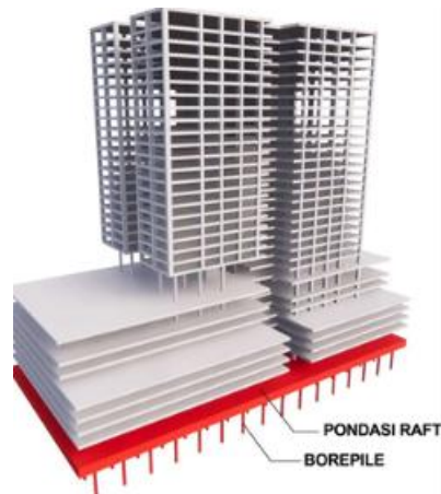
Gambar 16. Konsep Struktur Bawah (Sumber : Olahan Penulis, 2025)
