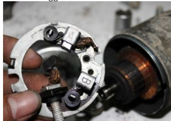
Gambar 4.1 Pemeriksaan sikat arang ( carbon Bush ) motor starter
