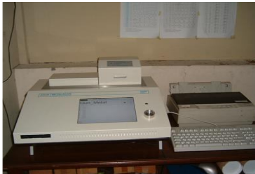
Gambar 5. Instalasi Pengujian Komposisi Kimia
