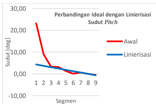
Gambar 13. Grafik perbandingan sudut pitch awal dengan linierisasi
