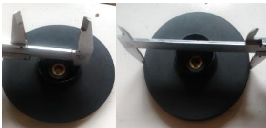
Gambar 10. pengukuran bagian diameter impeler
