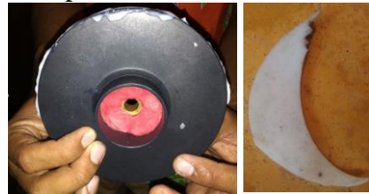
Gambar 6. Proses pencetakan Profil Impeller menggunakan karet silikon
