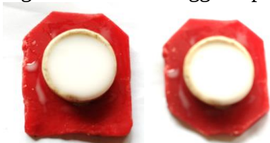
Gambar 5. Pengujian pencampuran karet silikon dengan hardener serta melihat apakah ada penyusutan pada hasil cetakan.
