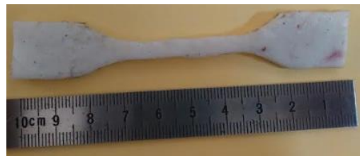
Gambar 8. Spesimen uji tarik karet silikon
