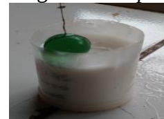
Gambar 4. Pengujian viskositas metode bola jatuh
