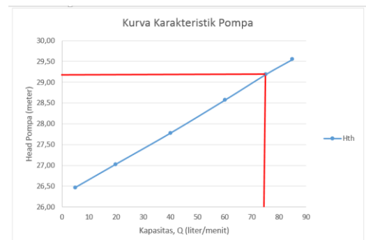
Gambar 18. kurva karakteristik pompa \beta_2 > 90^\circ
