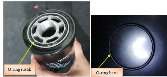
Gambar 6. Perbedaan o-ring yang rusak dan yang baru
