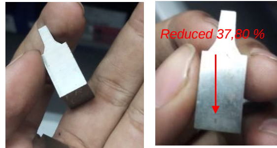
Gambar 3.3 Visualisasi Insert Inclined Core yang sudah selesai
