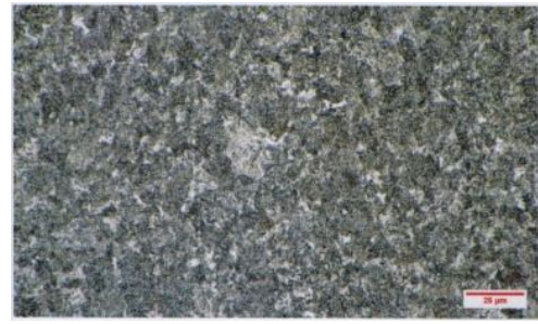
Gamb.3.5 Sampel Dasar Golok Dengan Media Air Garam Perbesaran 1000 X
