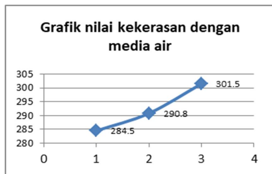
Gambar 4.4 Grafik Nilai Kekerasan dgn Media Air
