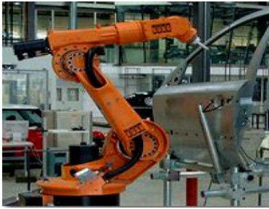
Gambar 2.2 Salah satu aplikasi Jig and Fixture untuk pintu mobil
