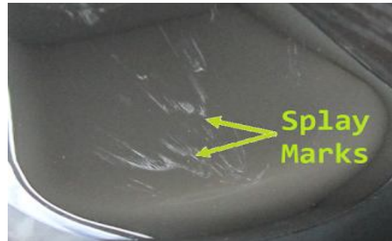
Gambar-6. Cacat Bercak Perak ( Splay )
