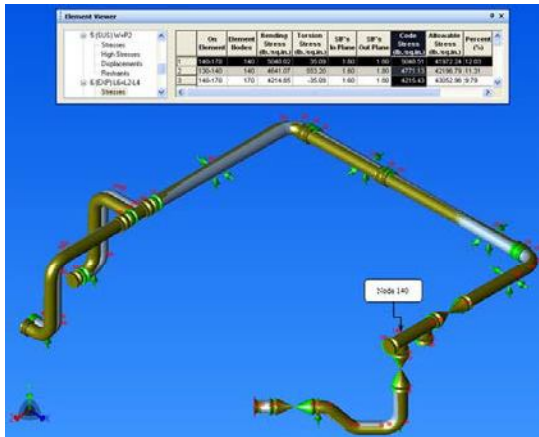
Gambar 4.2. Permodelan tegangan pipa akibat Beban Ekspansi (Sumber : Program CAESAR II)
