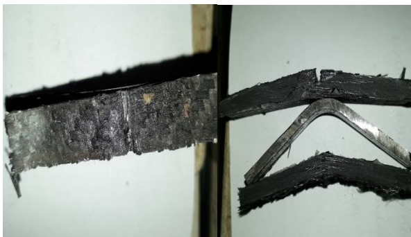
Gambar 11. Hasil benda uji Impact dengan lapisan 3 mm
