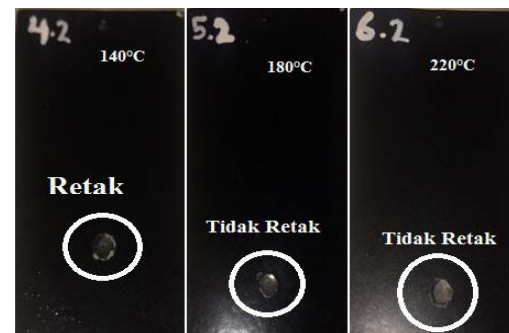
Gambar 4.5 Hasil impact test dengan ketinggian 40 cm
