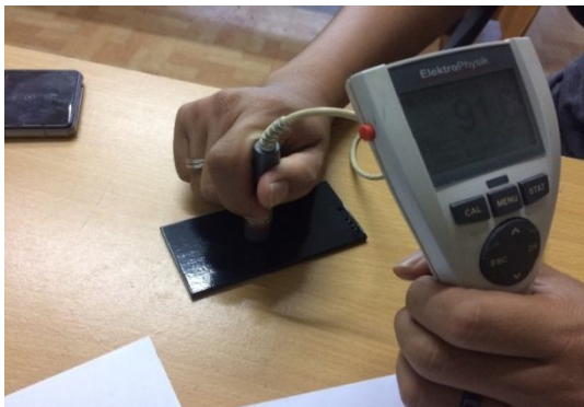
Gambar 3.7 Pengujian ketebalan lapisan dengan thickness gauge
