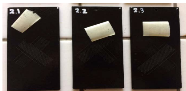
Gambar 4.2 Hasil uji cross cut suhu pengovenan 180°C
