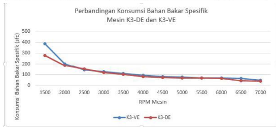
Gambar 6 Grafik Perbandingan Konsumsi Bahan Bakar mesin K3-DE dan K3-VE
