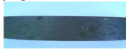
Gambar 6. Penampang permukaan kampas rem “ blong” (sumber data B4T, Bandung)
