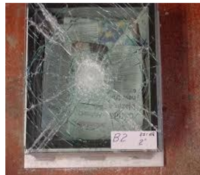
Gambar 4.6. Uji Benturan pada ketinggian 120 cm
