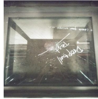
Gambar 4.5. Uji benturan pada ketinggian 75 cm.
