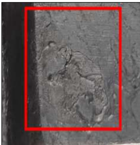
Gambar 1. Cacat Flowline Pada Part
