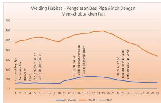
Gambar 24. Grafik Pengujian Dalam Welding Habitat Untuk Pengelasan Besi Pipa 6 inch Dengan Menghubungkan Fan.
