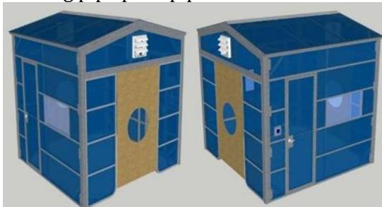
Design welding habitat pada proses welding pipa pada pipeline system
