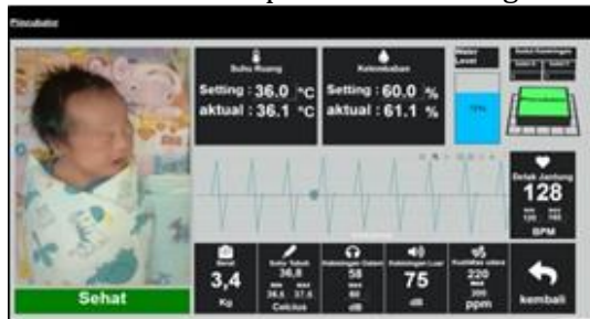
Gambar 17. Tampilan Untuk Petugas Medis Selain pencegahan kesalahan pengaturan parameter yang dengan perbedaan tampilan antara pengguna umum dan petugas medis, tampilan juga dilengkapi dengan alarm ketika terjadi ketidaksesuaian antara nilai aktual dengan rentang nilai yang maksimal dan minimal pada semua parameter yang telah diatur oleh petugas medis, untuk tampilan alarm dapat dilihat pada Gambar 18.
