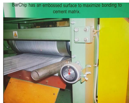
Fig. 3e Fibre Embossing Process
