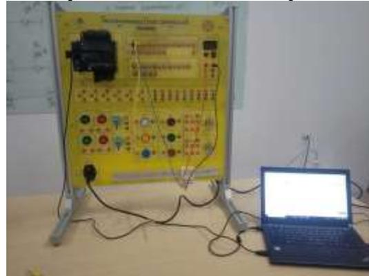
Gambar 9. Instalasi Sistem Konverter ke Trainer PLC Omron
