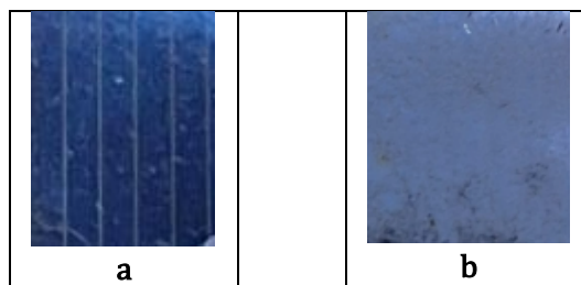
Gambar 5. Morfologi permukaan panel surya sebelum (a) dan sesudah (b) dilapisi komposit hydrogel nanosilika
