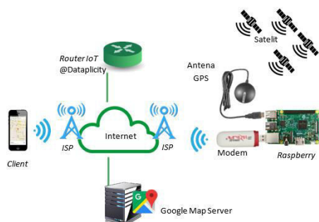
Gambar 2.7 Arsitektur GPS / Vehicle Tracker
