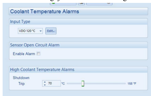
Gambar 17. Suhu maksimal air pendingin mesin
