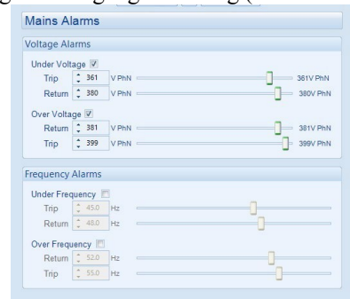
Gambar 22. Settingan under/over voltage pada mains
