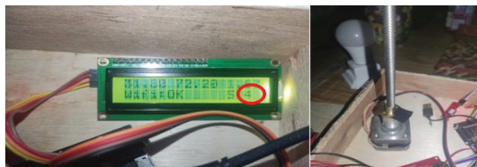
Gambar 4.7 SnoreCount mencapai nilai 4 (Kiri) dan pengujian motor stepper (kanan)
