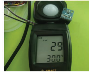
Gambar 4.3 Perbandingan hasil pembacaan BH1750 dengan Lux Meter
