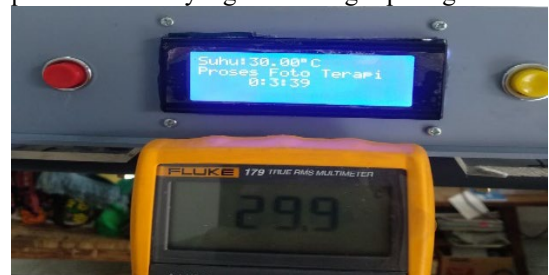
Gambar 21 Tampilan selisih prameter suhu avo meter dengan suhu alat.
