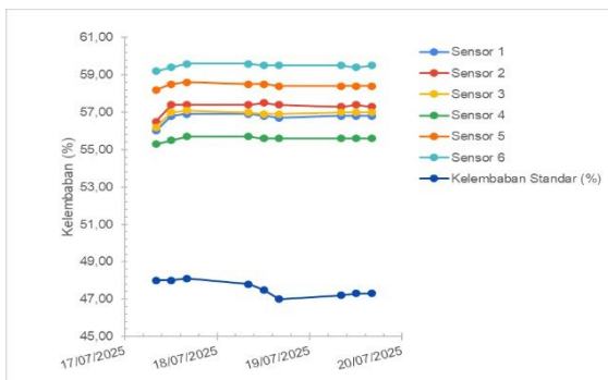
Gambar 13. Grafik Hasil Pembacaan Kelembapan Sensor DHT22
