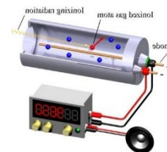
Gambar 2.1 Prinsip Kerja Geiger Müller
