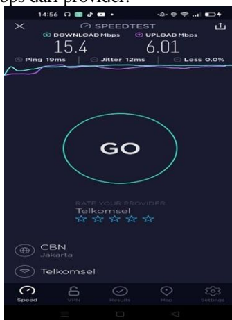
Gambar 12. Hasil pengujian kualitas jaringan dengan speedtest
