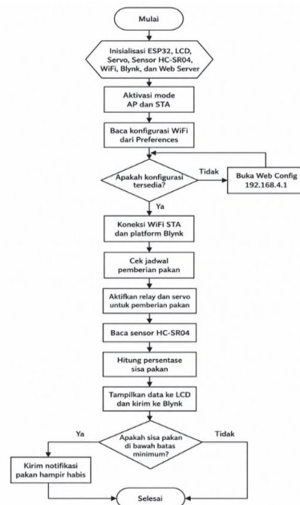
Gambar 2 Diagram alir Sistem Penebar Pakan Ikan Otomatis Berbasis IoT
